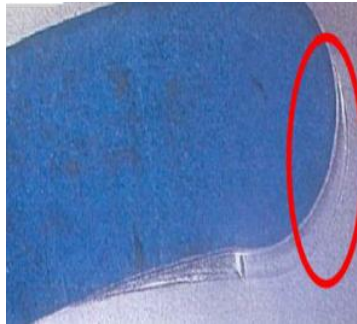
c) 层板裂纹：表面冲压裂纹，不可接受。
