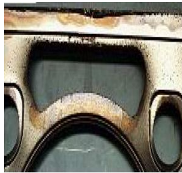
d) 涂层背部飞溅：厚度 < 10\ \mu\text{m} 可接受。
