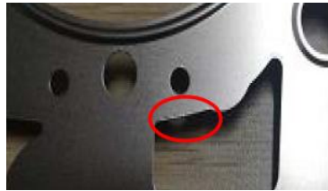
c) 涂层飞边：在各孔边缘存在 \leq 3\text{mm} 飞边，可接受。
