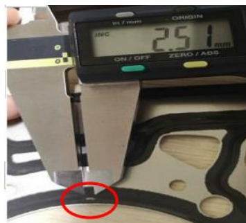
b) 密封功能区域非密封筋顶部，存在平行于波纹的连续划伤，长度 <3 mm可接受。
