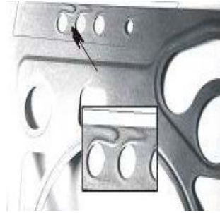
b) 涂层堆积在非密封功能区域：高度 \leq 0.1\text{mm} 、长度 < 1.5\text{mm} ，可接受
