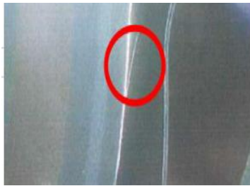
b) 层板毛刺：表面及各孔边缘毛刺，不可接受。
