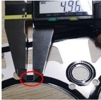
c) 密封功能区域非密封筋顶部, 存在平行于波纹的非连续划伤, 长度 <5\text{mm} , 可接受。
