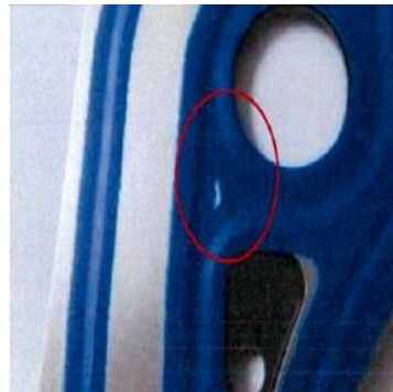
e) 非密封功能区域, 露金属底材的划伤, 长度 <10\text{mm} , 面积 <5\text{mm}^2 可接受。
