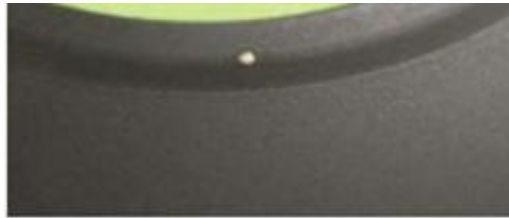
e) 露基材划伤：针孔状划伤，直径 \Phi 0.2\text{ mm} 以上，距离波纹顶部距离 \leq 1\text{ mm} ，不可接受。
