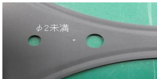
c) 露基材划伤：区域 \phi 2\text{ mm} 以下、近水孔旁5个以内，可接受。
